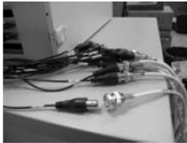
Рис. 3.1—5. Подключение видеокамер к интерфейсному кабелю
