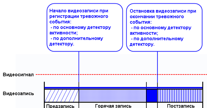
Рис. 4.2—38. Пример расширенной схемы формирования файла видеозаписи
