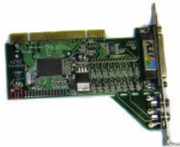
Рис. 3.1—29. Разъем подключения кабеля WatchDog на плате видеоввода
