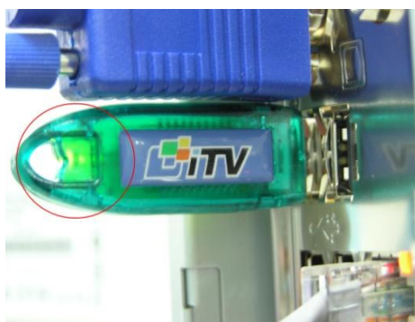
Рис. 3.1—55. Свечение индикатора на аппаратном ключе «Guardant»
