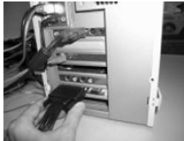
Рис. 3.1—4. Подключение интерфейсного кабеля
