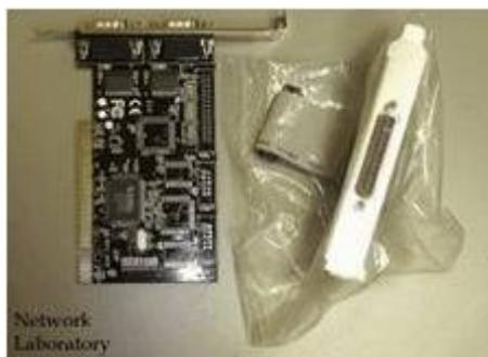
Рис. 4.2—2 Плата расширения COM-портов
