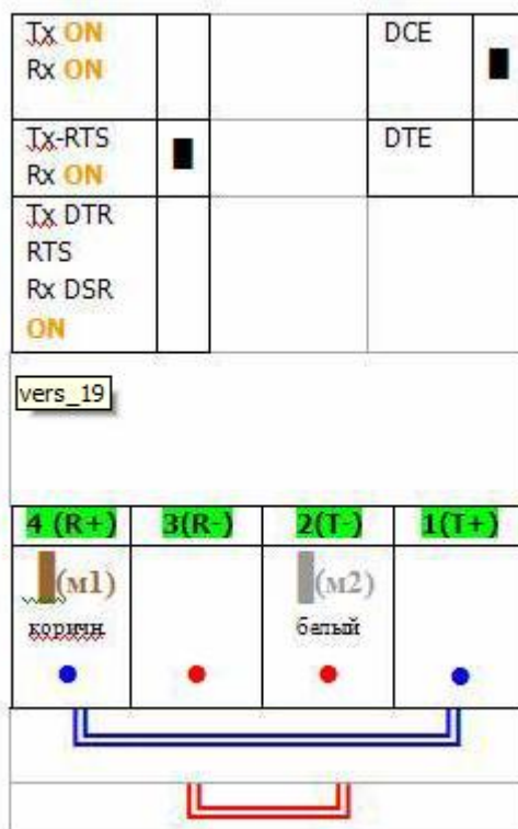
Рис. 5.2—1 Схема подключения прибора ВЭРС-ПК24мм по COM-порту
