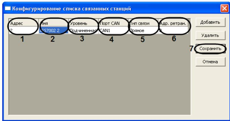
Рис. 3.3-7 Параметры станции
