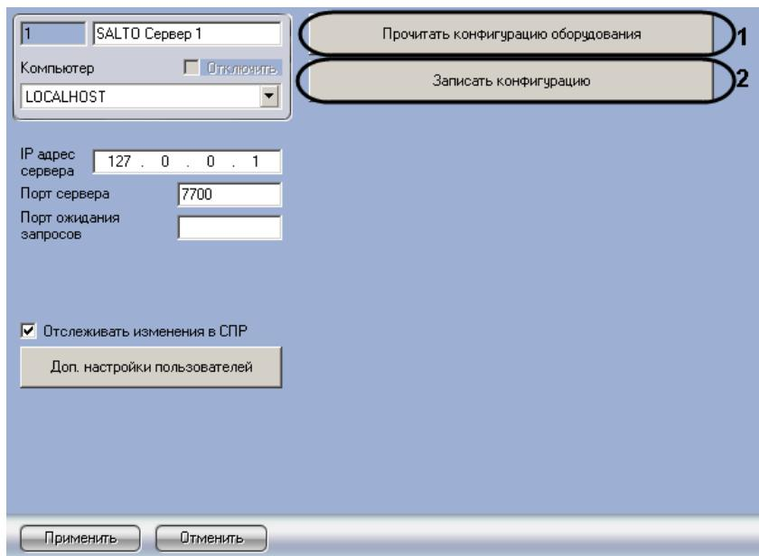
Рис. 3.3—3 Загрузка и запись конфигурации СКУД SALTO
