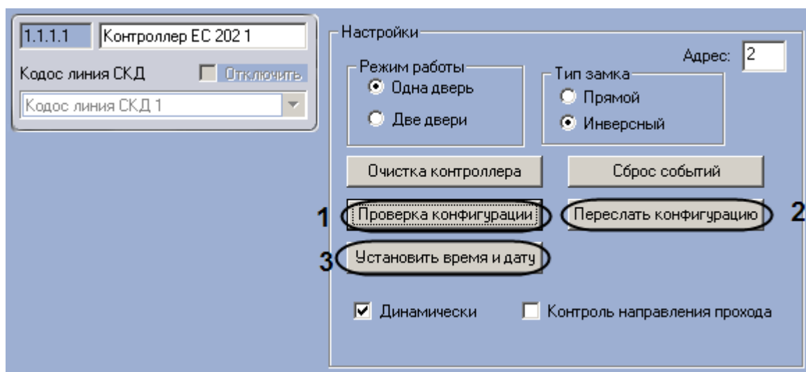
Рис. 3.5—5 Настройка конфигурации контроллера ЕС 202
