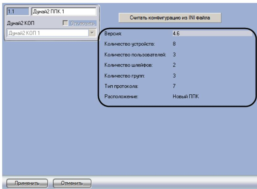
Рис. 3.3—4 Пример отображения информации о конфигурации Дунай2 ППК
