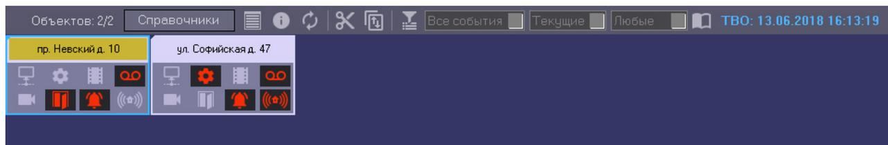
Каждому объекту соответствует графический элемент в виде прямоугольника, внутри которого находится область идентификации объекта (в верхней части) и настраиваемое количество клавиш-индикаторов тревог, сформированных в группы по типу источников:
