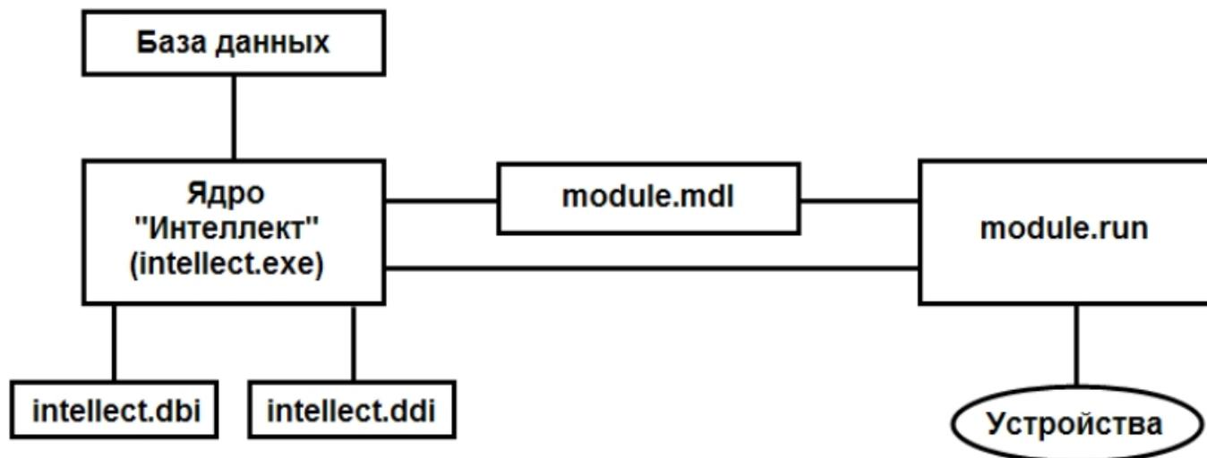
DBI- и DDI-файлы содержат необходимую для функционирования ядра системы информацию об интегрированных функциональных модулях (объектах). DBI-файл содержит описание структуры конфигурационной базы данных ПК *Интеллект*. В DDI-файле хранится описание объектов и их параметров. При интеграции объекта в данные файлы заносят наименование, параметры интегрируемого объекта, связанные с ним системные события и реакции.
