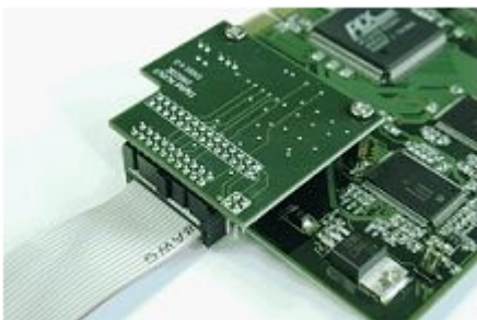
Пример подключения интерфейсного кабеля к плате лучи-реле 4/4
