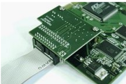
Пример подключения интерфейсного кабеля к плате лучи-реле 4/4
