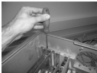
Пример установки платы видеоввода FS-6С в PCI слот
