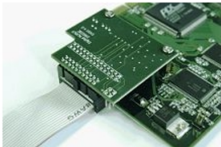
Пример подключения интерфейсного кабеля к плате лучи-реле 4/4
