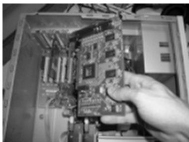
Пример установки платы FS-16 в PCI-E X1 слот
