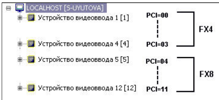
Распределение PCI-каналов для плат, сконструированных на основе одной модели чипа (АЦП)
