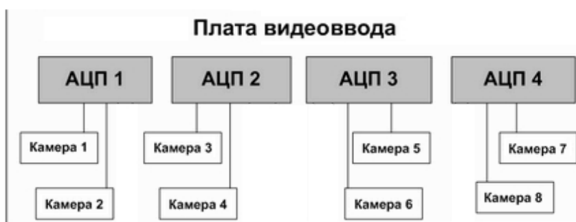
А. равномерное распределение видеокамер между АЦП
