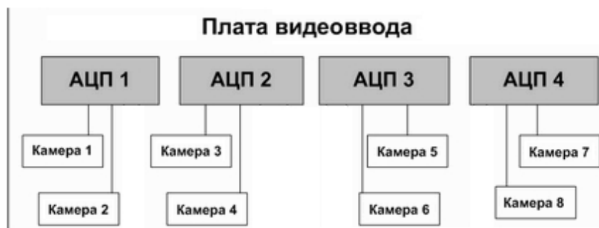
А. равномерное распределение видеокамер между АЦП
