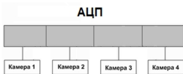
А. равномерное распределение видеокамер между АЦП
