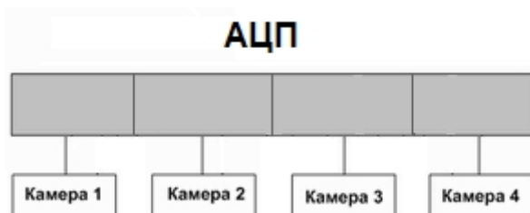
А. равномерное распределение видеокамер между АЦП
