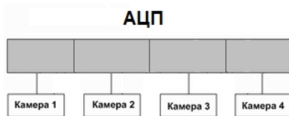
А. равномерное распределение видеокамер между АЦП
