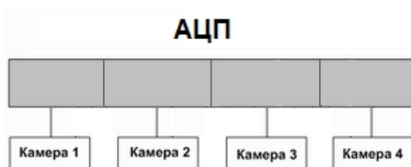
А. равномерное распределение видеокамер между АЦП
