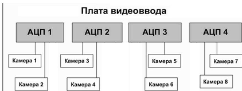
А. равномерное распределение видеокамер между АЦП
