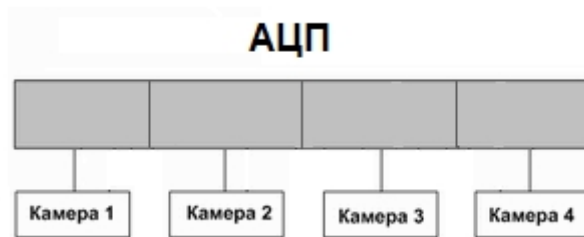
А. равномерное распределение видеокameraми между АЦП
