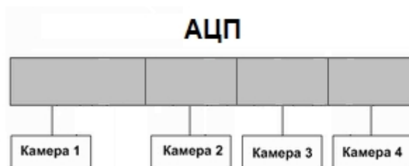
Б. перераспределение видеокameraми между АЦП для выделения дополнительных ресурсов видеокameraми №1
