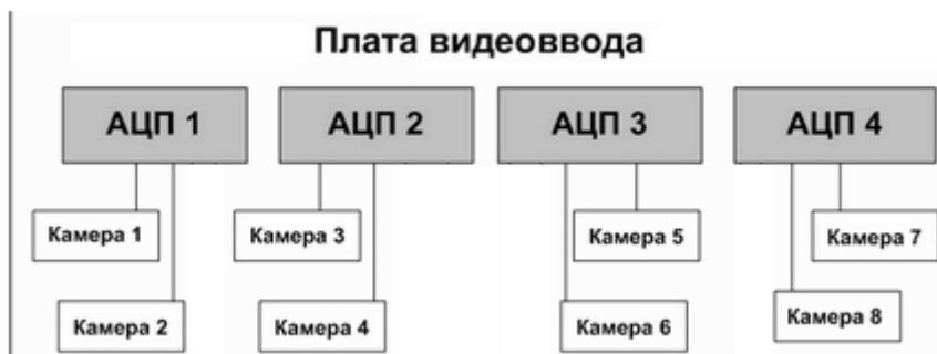
А. равномерное распределение видеокамер между АЦП
