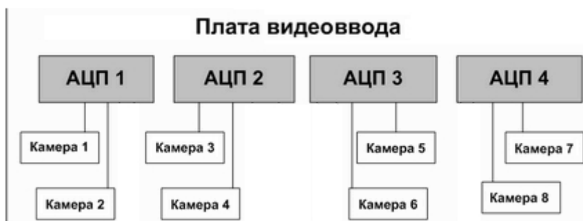
А. равномерное распределение видеокамер между АЦП
