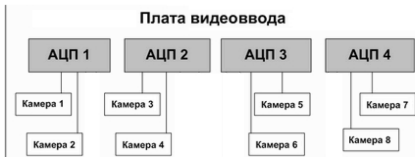
А. равномерное распределение видеокамер между АЦП
