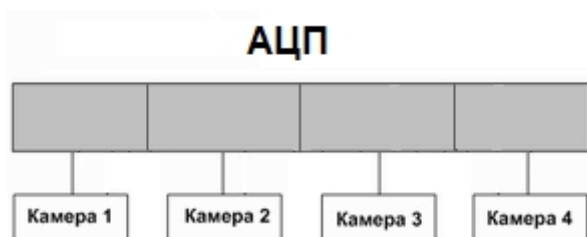
А. равномерное распределение видеокамер между АЦП
