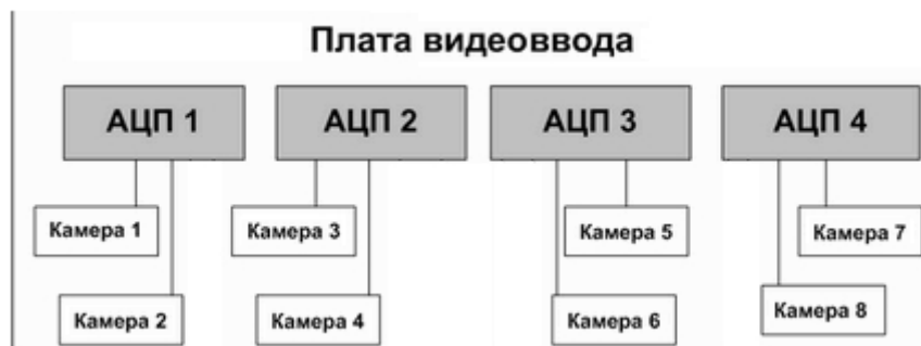
А. равномерное распределение видеокамер между АЦП
