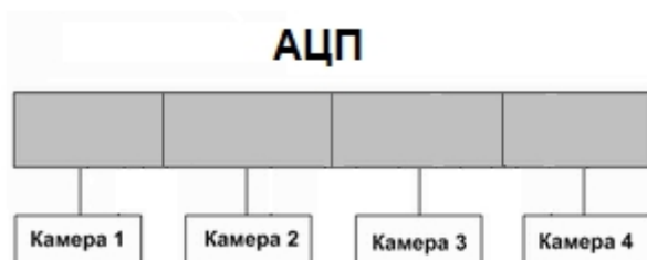
А. равномерное распределение видеокамер между АЦП
