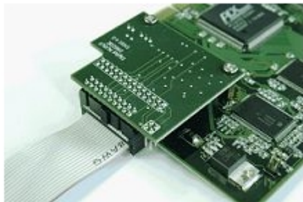
Пример подключения интерфейсного кабеля к плате лучи-реле 4/4
