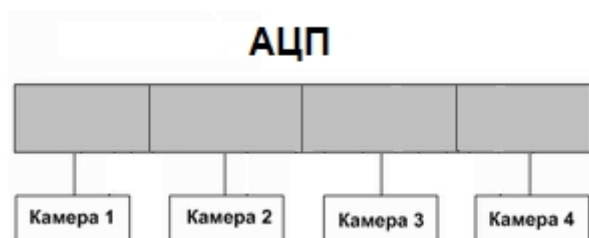
А. равномерное распределение видеокамер между АЦП
