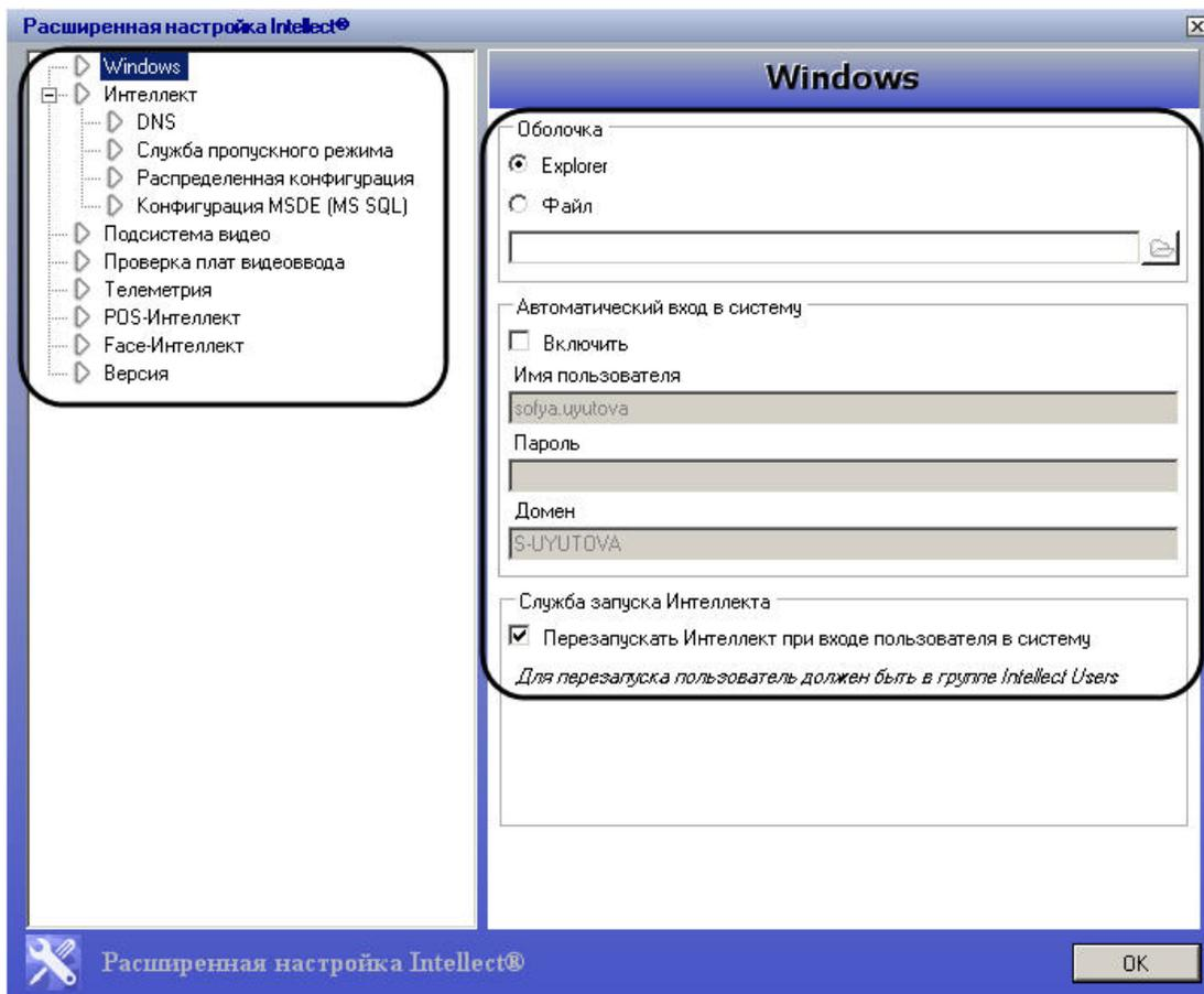
Дерево разделов диалогового окна tweeki.exe имеет статичную структуру и предназначено для обеспечения навигации при работе с утилитой. Для доступа к панели настроек требуемого раздела следует произвести щелчок левой кнопкой мыши по соответствующей вкладке дерева.
