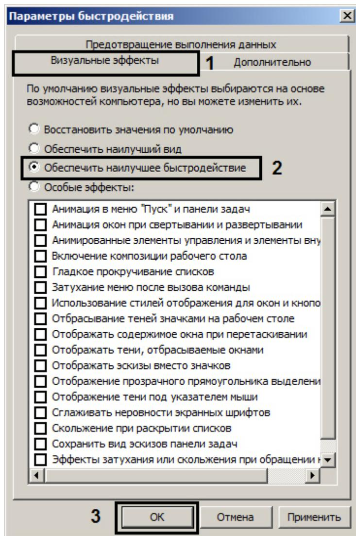
4. Установить переключатель в положение **Обеспечить наилучшее быстродействие** (2).
