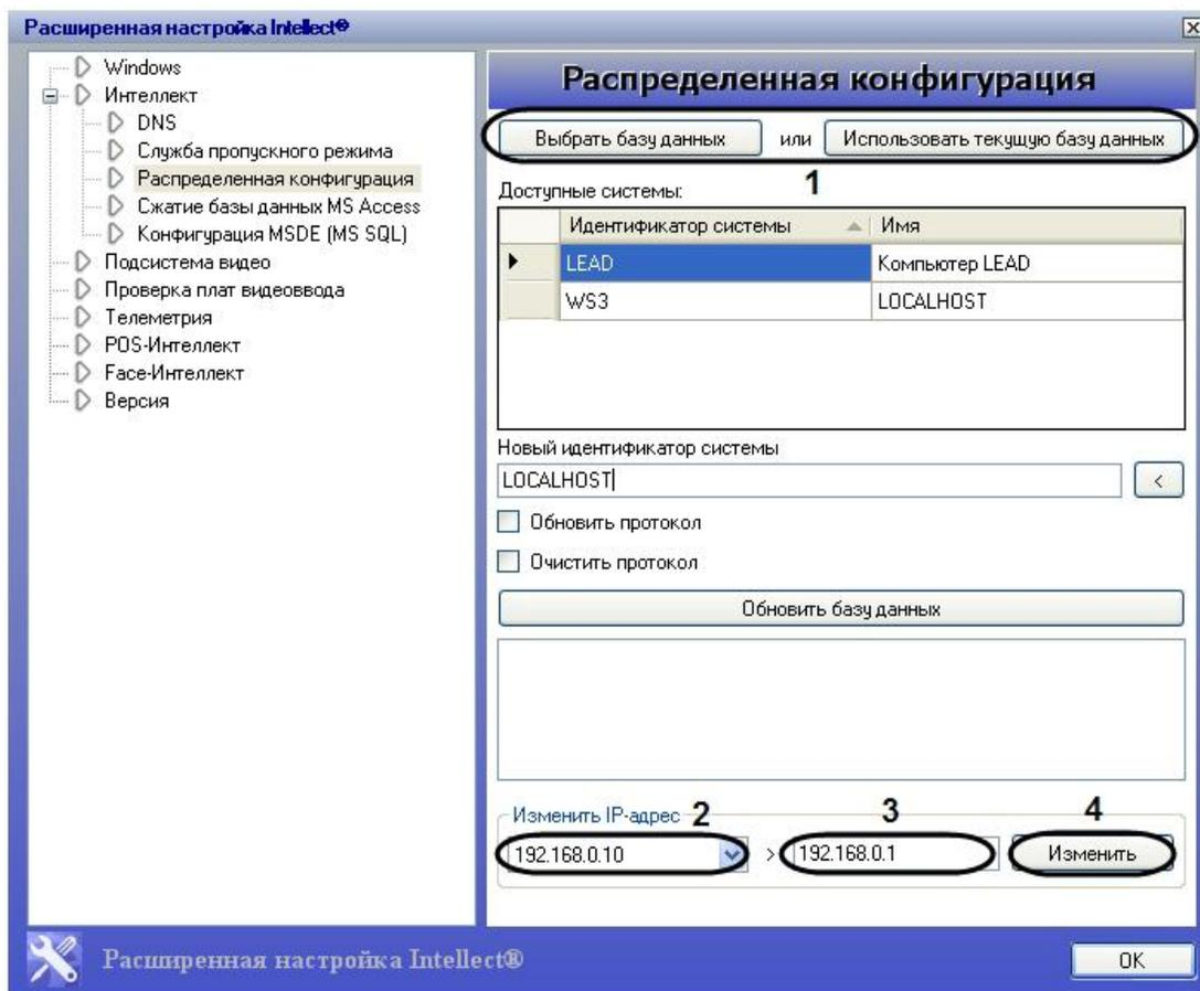
В результате произведенных действий IP-адрес в базе данных будет изменен.
