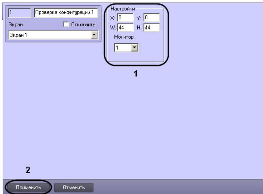
4. Для настройки положения окна утилиты *Проверка конфигурации* установить значения координат левого верхнего угла окна в полях **X:**, **Y:** и значения ширины и высоты окна в полях **W:**, **H:**, а также выбрать монитор компьютера, для которого задаются эти координаты (1).
