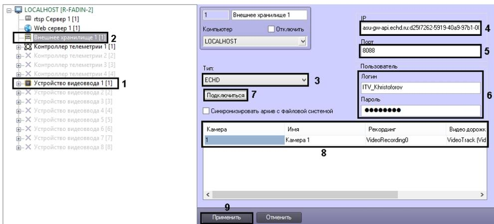
2. Создать объект **Внешнее хранилище** на базе объекта **Компьютер** на вкладке **Оборудование** диалогового окна **Настройка системы** (1).
