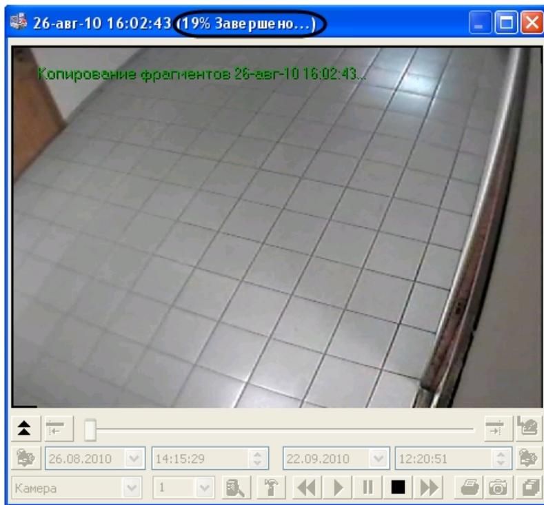
По окончании процесса экспортирования в строке состояния будет выведена надпись **Завершено**. Для проверки результата экспортирования необходимо зайти в автоматически созданную папку **Backup** и найти файл с названием, соответствующим устройству, из архива которого была экспортирована запись.
