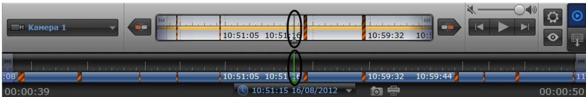
Перемещение по основной и дополнительной шкале производится синхронно.
