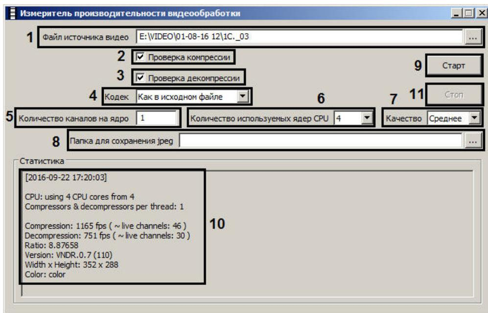
3. Для проверки, сколько кадров в единицу времени может компрессировать данный компьютер, установить флажок **Проверка компрессии** (2).
