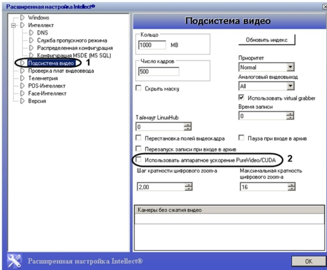
4. Установить флажок **Использовать аппаратное ускорение PureVideo/CUDA** (2).
