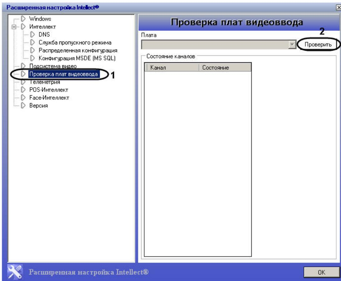
В результате поле **Плата** будет содержать наименование платы видеоввода, в таблице **Состояние каналов** отобразится информация о каждом канале платы видеоввода (номер канала, статус канала), справа от таблицы **Состояние каналов** будет выведено сообщение об успешном завершении процесса тестирования.
