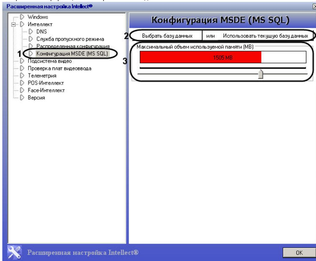
5. Передвинуть ползунок при помощи мыши в то положение, которое соответствует настройкам объема оперативной памяти, выделяемой для работы SQL-сервера (3).
