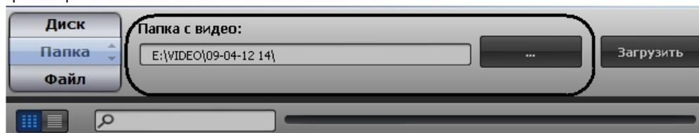
с. В случае, если выбран способ **Файл**, нажать на кнопку
