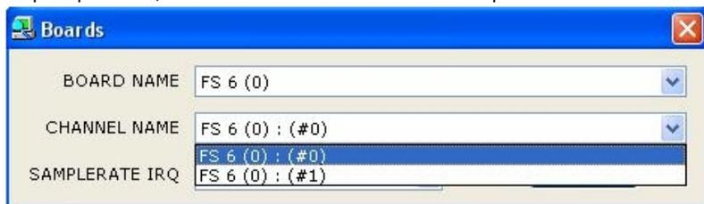
4. Из раскрывающегося списка **SamplerAte IRQ** выбрать частоту оцифровки аудиосигнала.
