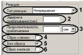
а. Выбрать тип реакции исполнительных устройств в раскрывающемся списке Тип реакции **(1**).
