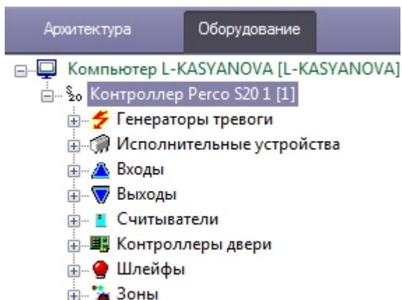
На панели настроек объекта **Контроллер Perco S20** будет отображен IP-адрес обнаруженного контроллера и версия его прошивки.
