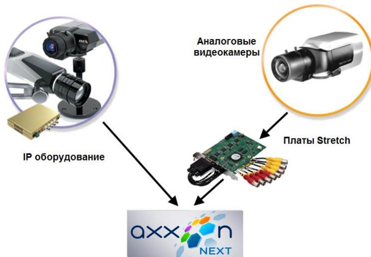
Рис. 1-1 Гибридная система безопасности на базе ПК Axxon Next
