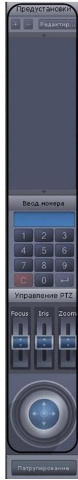
Рис. 6-5 Панель управления поворотными устройствами
