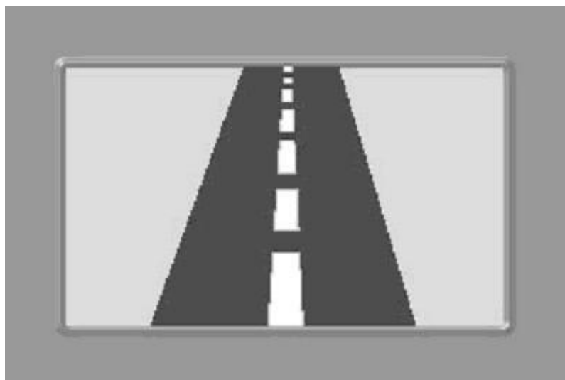
Рис. 6.2—3. Изображение дороги, соответствующее рекомендуемому расположению видеокамеры
