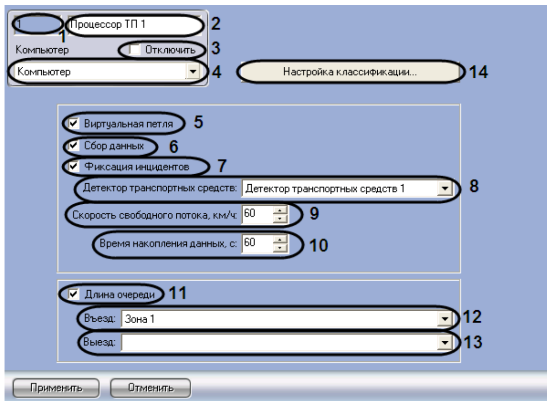
Рис. 8.6—1. Панель настройки системного объекта «Процессор ТП»
