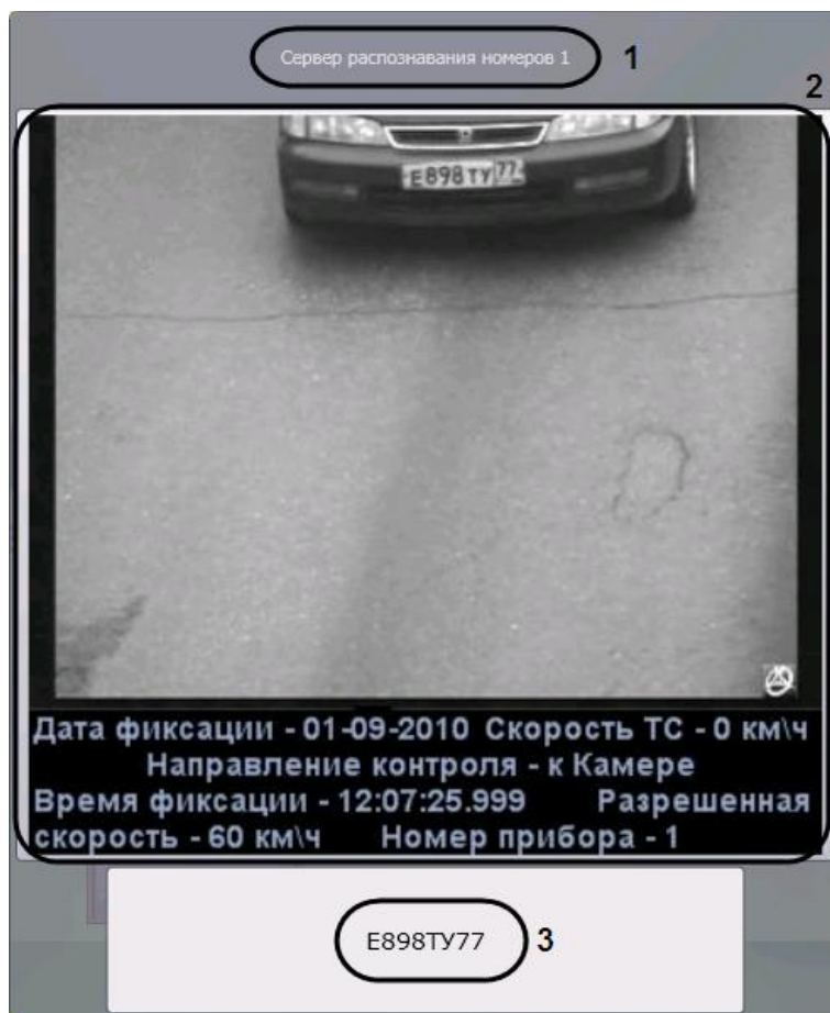
Рис. 4.3-1. Просмотр сведений о проезжающем ТС
