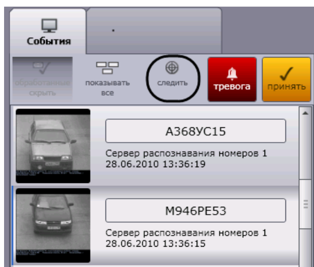
Рис. 4.3-6. Восстановление оперативного обновления протокола обнаруженных ТС
