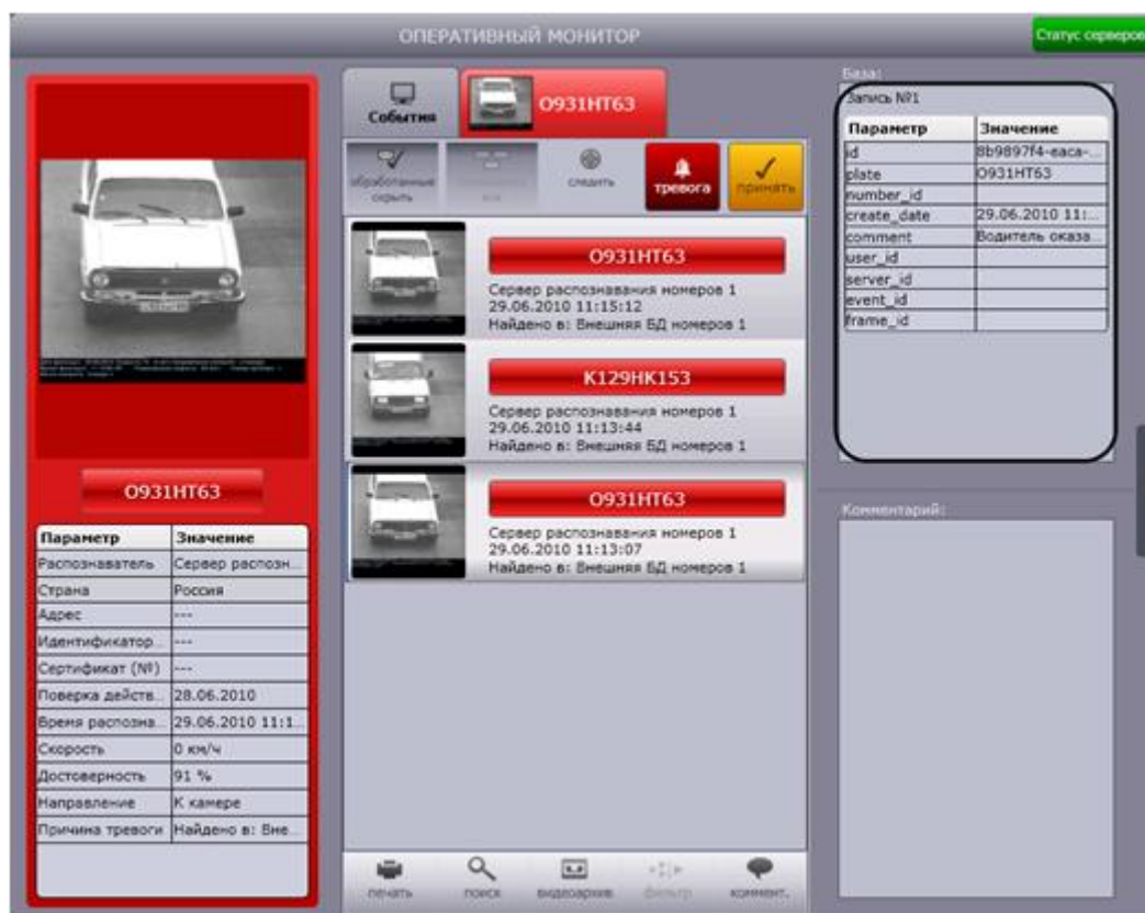
Рис. 4.3-10. Сведения о ТС из внешней базы данных номеров
