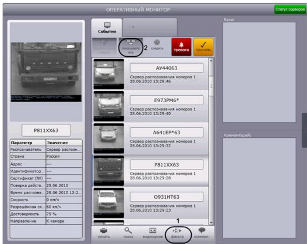
Рис. 4.3-19. Использование фильтров в протоколах
