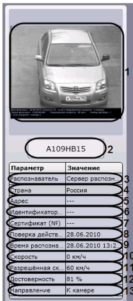
Рис. 4.3-3. Просмотр сведений о последнем обнаруженном ТС
