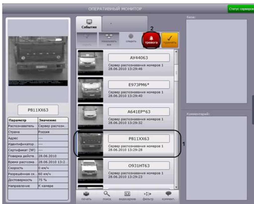
Рис. 4.3-7. Инициация тревожного события вручную
